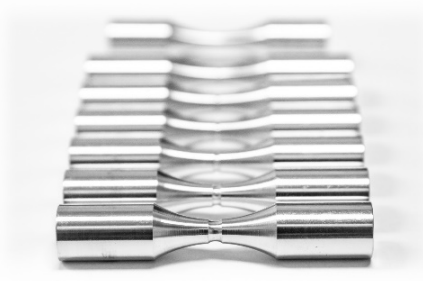
Vzorky s vrubem pro ultrazvukové únavové testy
