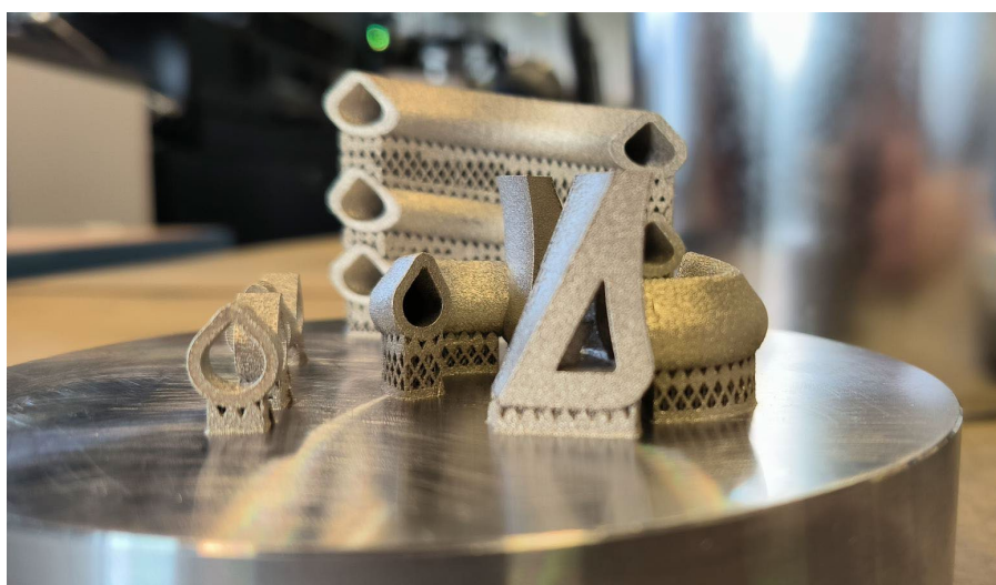
Úspěšná výroba kritických prvků hlavy plynového hořáku pomocí LPBF.
