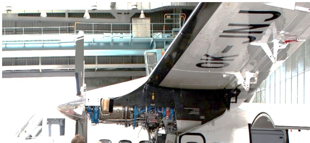
Na obrázku je inovované motorové lože (foto Aircraft Industries, a.s.)
