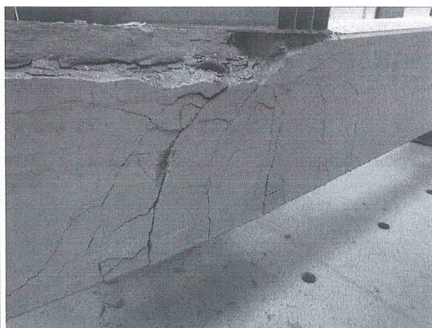
Obr. 4 Nosník 12 – C1 (po zkoušce): celkový pohled (vlevo); detail (vpravo)
