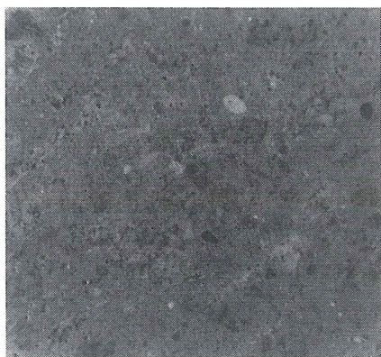
Obr. 1 Struktura alkalicky aktivovaného kompozitu
