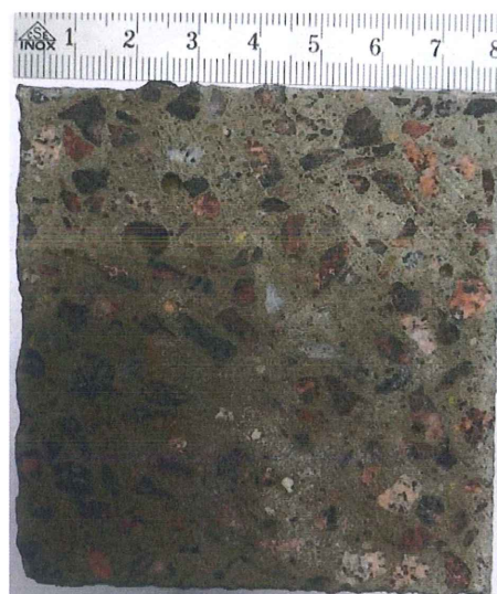
Obr. 4. Struktura studovaného betonu kamenivo do 8 mm směr sedání
